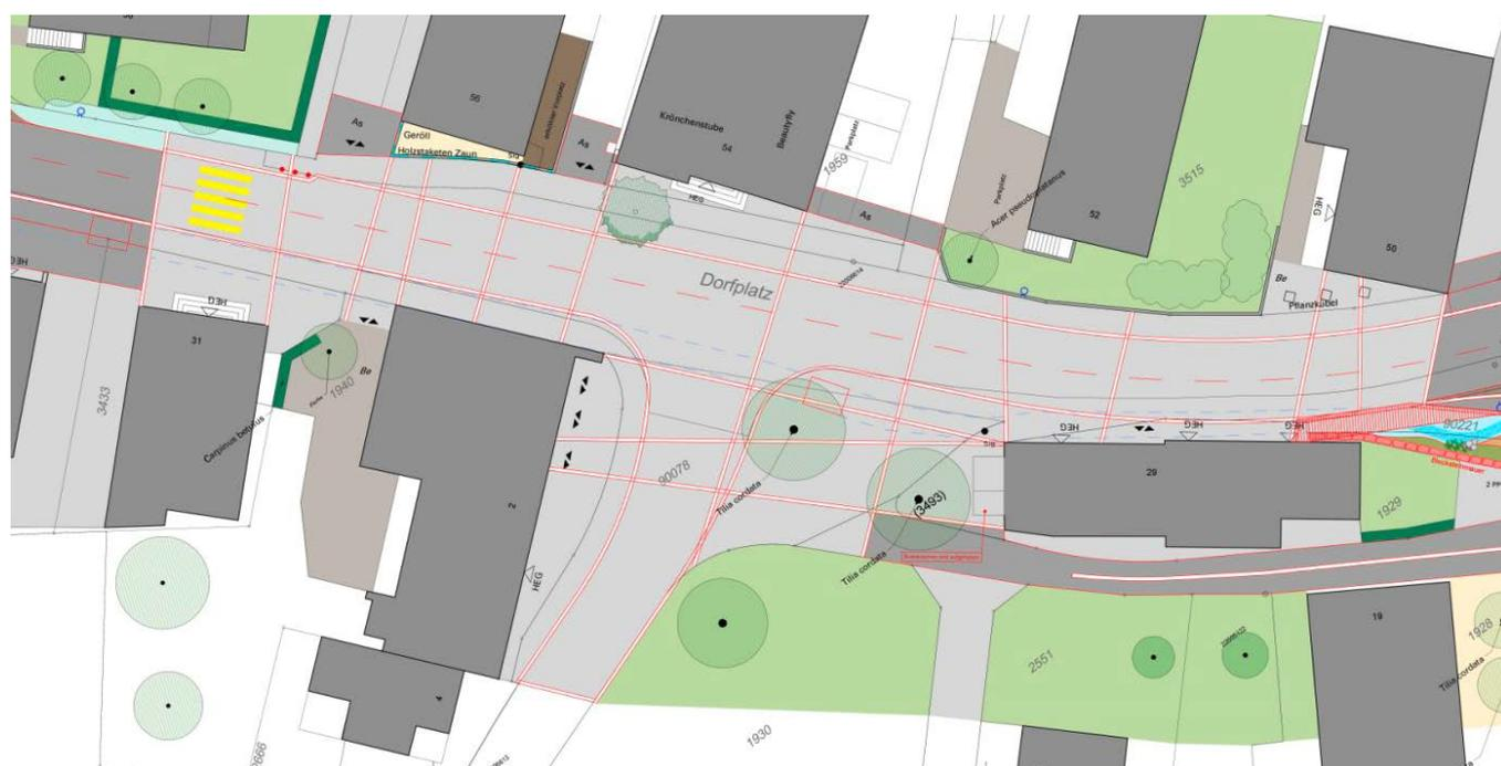
**Der neu gestaltete Dorfplatz: Die ebenerdig verlegten Gestaltungssteine strukturieren den Platz und sorgen damit für mehr Aufmerksamkeit und somit auch für eine angepasste Fahrweise. Dieses Prinzip ist bei beiden Varianten (Tempo 50 / Begegnungszone im Bereich des Dorfplatzes) gleich.**
