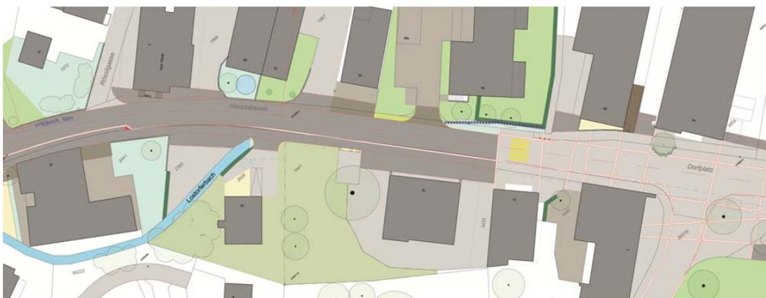
Beim Dorfplatz hat man sich zum Ziel gesetzt, mit einer Materialisierung das Tempo auf der Strasse zu reduzieren. Mit der Materialwahl (Steinreihen) soll dem Autofahrer aufgezeigt werden, dass auf der Strasse im Bereich Dorfplatz „etwas passiert“. Der Dorfplatz wird dadurch aufgewertet und gleichzeitig wird dadurch die Geschwindigkeit reduziert.
