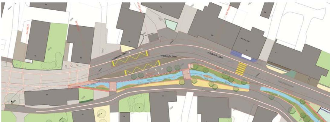
Der vorstehende Bereich wird ebenfalls charakterisiert durch die Randabschlüsse und die neuen behindertengerechten Bushaltestellen (auf der Hauptstrasse). Mit der Bachoffenlegung wurde dieser Bereich am meisten aufgewertet. Ebenfalls sind kleine Brücken mit Gehwegen vorgesehen. Der Bach wird mit einem Geländer geschützt. Die Bäume und Pflanzen im Bach sind artgerecht und werden vom Hochwasser sicher nicht weggespült.
